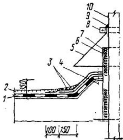
Рис. 3. Пример решения пропуска труб
